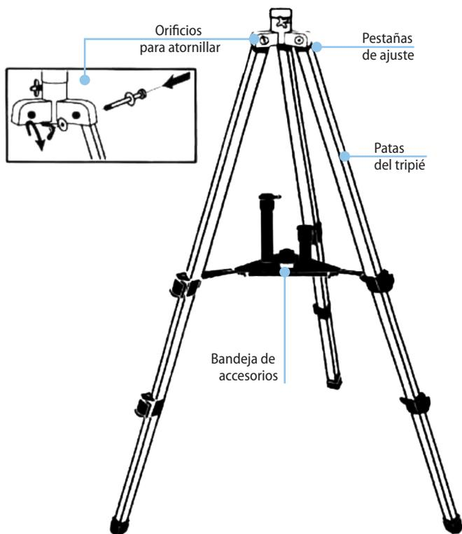
Ojo: Todos los tornillos deben colocarse de forma firme pero suave, sin ejercer demasiada presión para evitar barrerlos.
